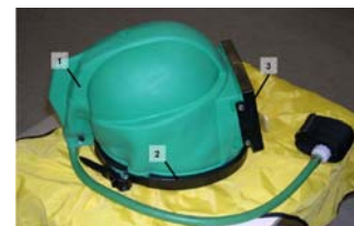
Tilleggsutstyr. Gummitrekk som beskytter hjelmshakket mot slitasje og reduserer støyen fra rikosjetterende blåsemiddel.
